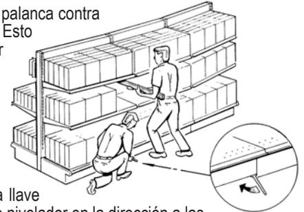
**6.** Compruebe si el Poste está a nivel con el Nivelador. Repita el proceso (Etapas 2-6), si es necesario, hasta que el Poste esté nivelado.
