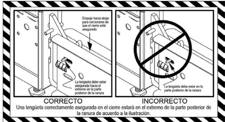
Al remover la pata, deberá remover los entrepaños superiores antes de desenganchar la pata del poste.
